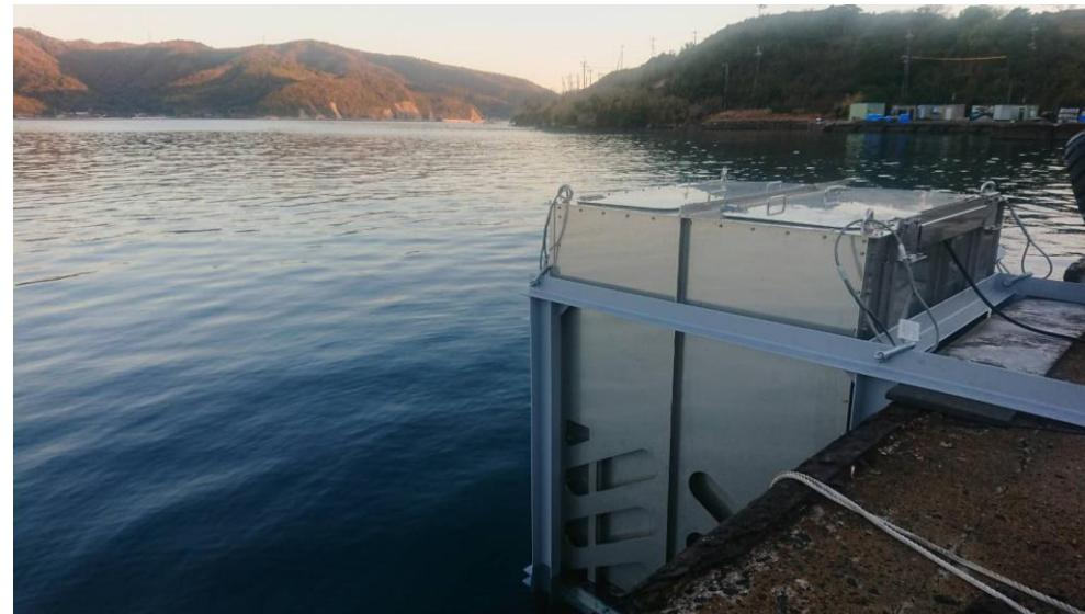
写真：小型波力発電装置「往復型回転加速式発電」
